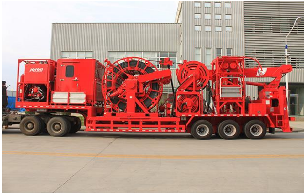
شکل ۲-CT(Trailer Model) - مدل تریلر برای عملیات‌های با حجم سنگین و با عمق زیاد
