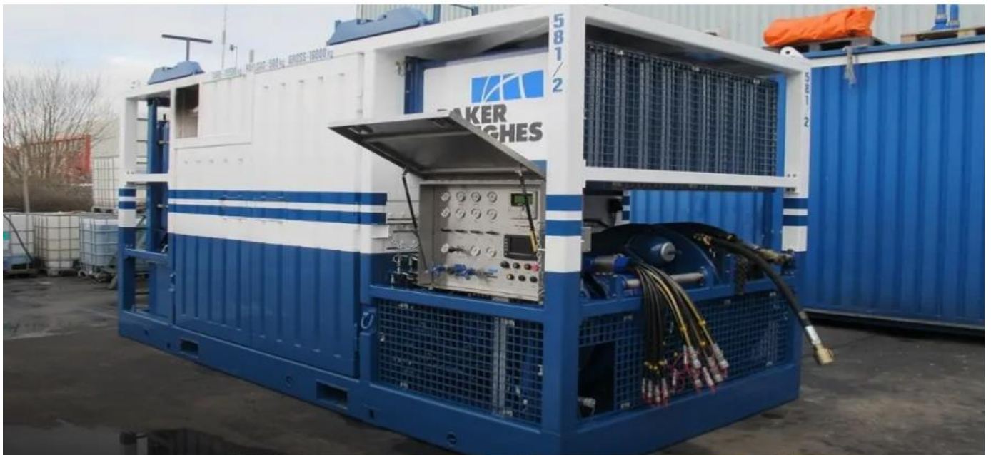
شکل ۹- تصویری از سیستم تأمین توان و هیدرولیک شرکت بیکرهیوز
