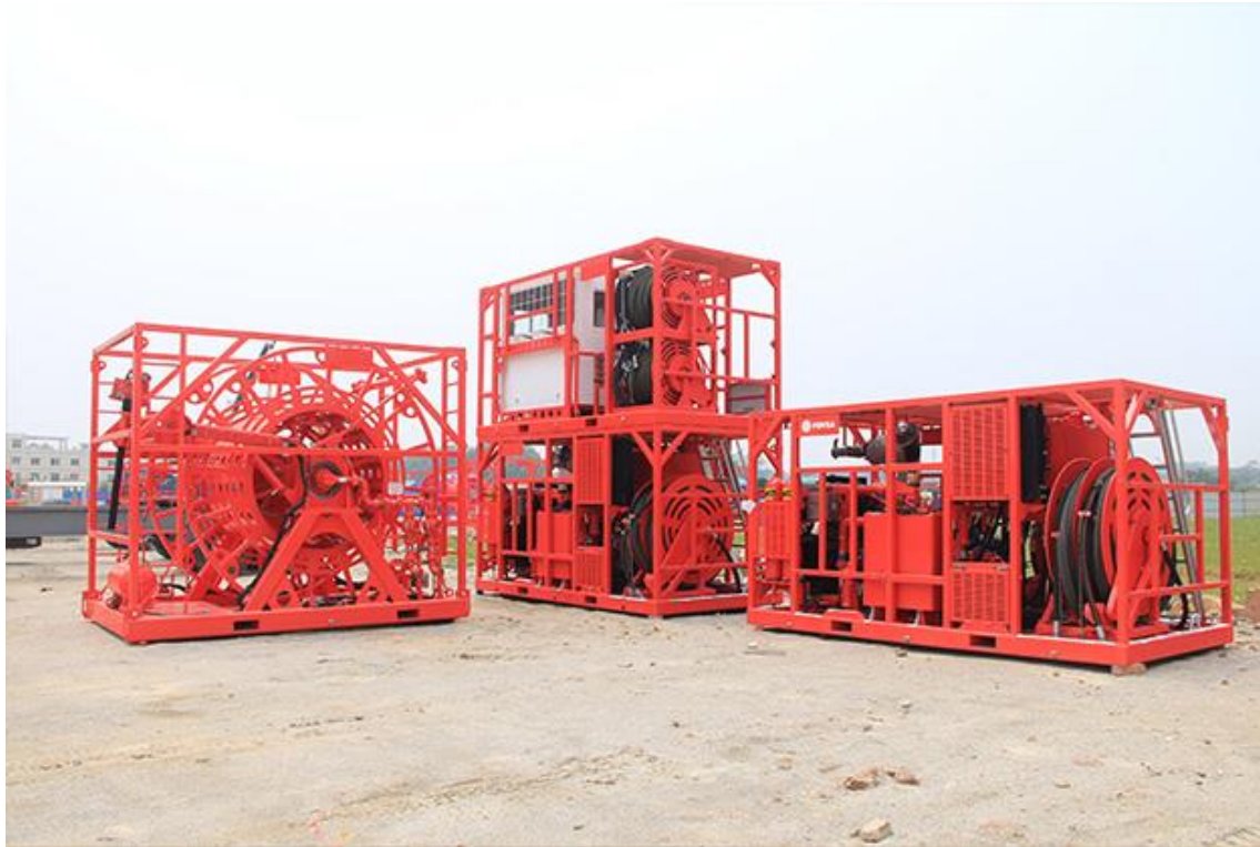
شکل ۴- CT(Skid Model) - مدل اسکید برای عملیات‌های دریایی
