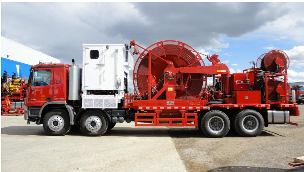
شکل ۳-CT(Truck Model) - مدل تراک برای عملیات‌های با حجم متوسط
